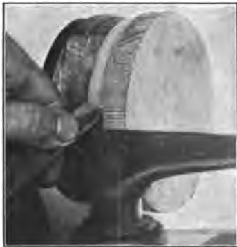
Fig. 124. Turning Edge of Rosette.
